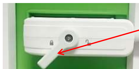
Abbildung 28: Ausrichtung des Sondensteckers
