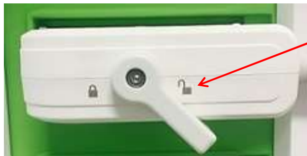
Abbildung 29: Entriegelter Verriegelungsknopf am Sondenstecker
